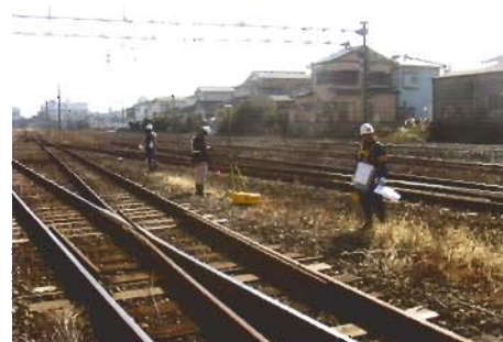
▲鉄道用地内にある基準点の経年経過の管理
