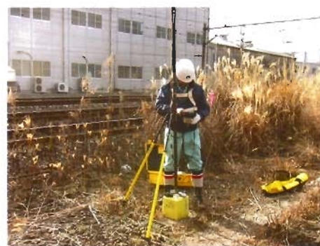
▲鉄道用地内にある基準点の経年経過の管理
